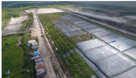
Adatube technology to manage mine sludge Teknologi Adatube untuk mengelola lumpur tambang
